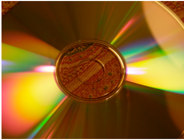
Figure F4.1 : Diffraction de la lumière par les sillons d'un disque laser
