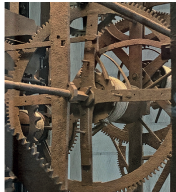
Figure 4 : Mouvement de l'horloge astronomique de la cathédrale de Bourges (1424) par Jean Fusoris, serrurier André Cassart) [22]
