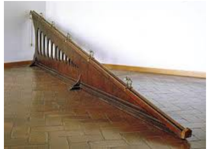
Figure 5 : Dispositif imaginé par Galilée pour étudier la chute des corps (Musée Galileo Galilei, Florence)
