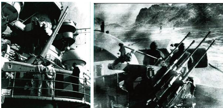
Figure 10 – Artillerie secondaire anti aérienne. Tourelle double de 105mm et quadruple de 20mm
