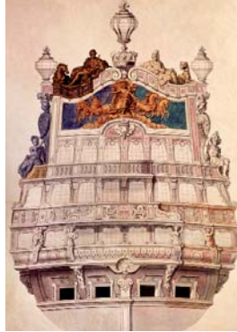
Figure 6 : Gaillard d'arrière du Soleil Royal, face posté- rieure. Noter les fanaux au sommet et les sabords de fuite en bas. N. Siméon : Louis XIV et la mer.
