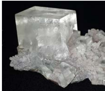
Photo 1 : Échantillon de calcite de la collection de l'Université Paris VI. Longueur 6 cm environ. Provenance : Namibie. Angles : 102 et 78 degrés (donc pas exactement des angles droits). Photo Jean-Paul Legros.
