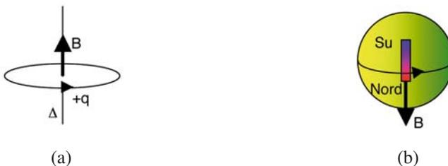
Figure F4.2 : (a) une charge électrique positive  $+q$  décrivant une spirale d'axe  $\Delta$  crée une induction magnétique  $B$  alignée suivant  $\Delta$  ; (b) un électron tournant sur son axe crée une induction alignée sur cet axe, il est équivalent à un petit aimant.
